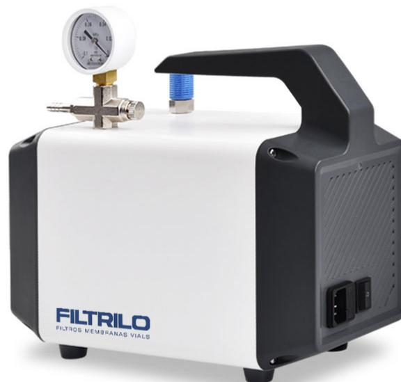
As bombas de vácuo da linha BV são amplamente utilizadas para filtração de fase móvel, filtração de água ultrapura, concentração de amostras, extração em fase sólida (SPE), indústrias petroquímicas e farmacêuticas, destilação, e para outros fins.
